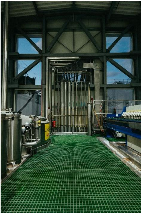
**Cuve whirlpool (à gauche) et filtre à plaques (à droite).**
